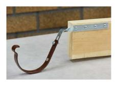
1.4 Прямой удлинитель или усиленный кронштейн применяются, если кровельное покрытие еще не смонтировано. Их крепят к стропильной ноге или обрешетке под кровельное покрытие.
