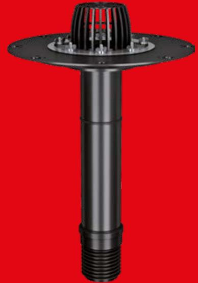
Кровельная ремонтная воронка применяется для быстрого монтажа в существующую магистраль водоотведения на крыше при проведении капитального ремонта. Воронка комплектуется листоуловителем и обжимным фланцем из нержавеющей стали без нагревательного элемента.
